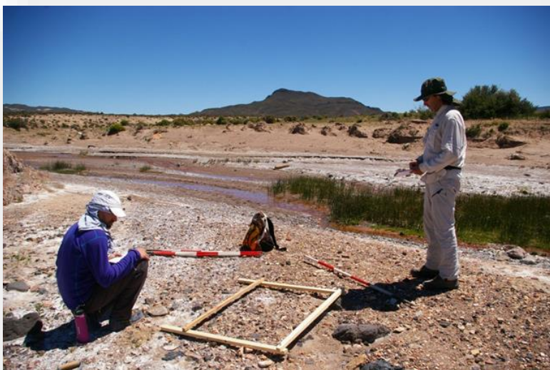
Rodrigo Bastida (izquierda) y Érico Bianchi (derecha) realizando la caracterización de los sedimentos del lecho del Arroyo Perdido
