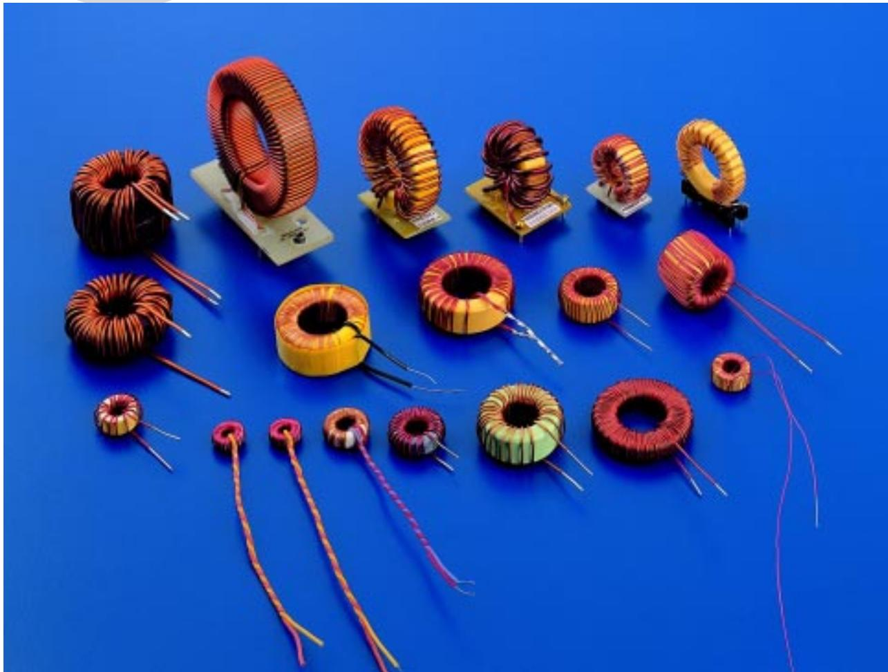
Los choques toroidales de almacenamiento de energía están bobinados sobre un núcleo toroidal de polvo de hierro cuyo entrehierro está perfectamente controlado debido a su proceso de fabricación, así como está debidamente tipificada la energía máxima que puede almacenar cada modelo manteniendo la inductancia en vacío y a plena carga.
