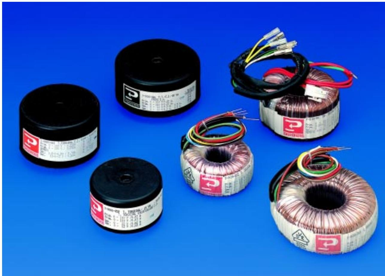
Los transformadores toroidales Premo reúnen las muchas ventajas eléctricas y mecánicas. El aislamiento principal entre primario y secundario consiste en una doble capa y triple solapado de cinta de poliéster, que supera los 3kVac. El incremento de temperatura del bobinado en plena carga, en régimen permanente, puede aumentar en 65°C por encima del ambiente. En la superficie externa el incremento no excede de los 45°C.
